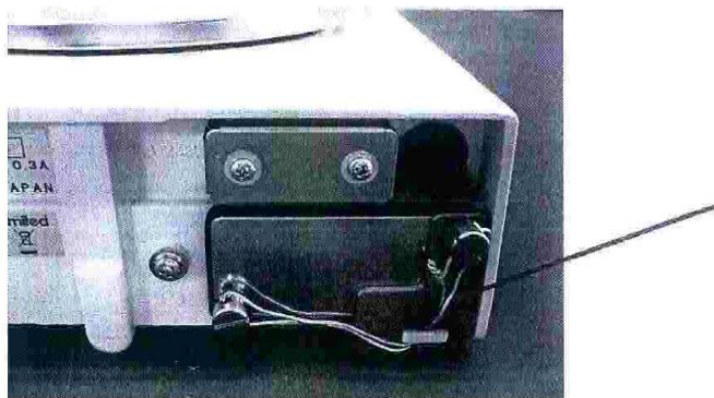
Рисунок 2 – Схема пломбировки весов
